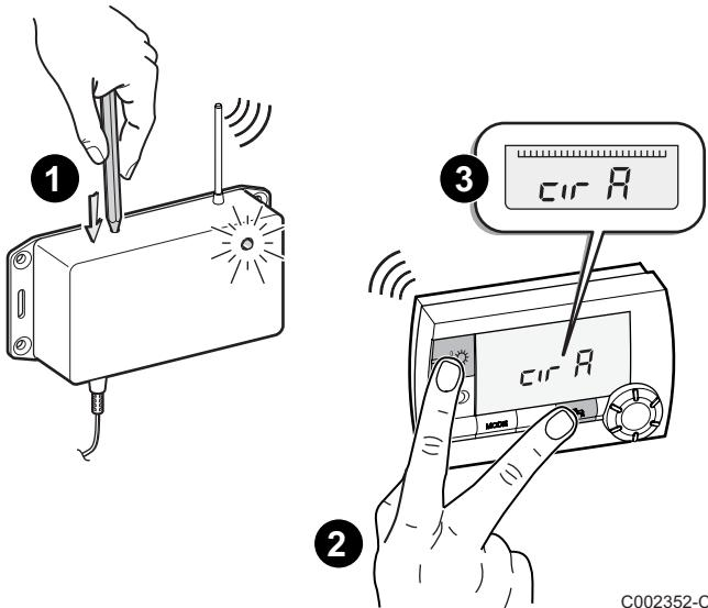
**1** Hrotom propisovací tužky stisknout tlačítko na radiovém modulu. Kontrolka na radiovém modulu se rozsvítí.
