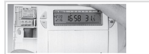
vaši ② Upevněte sokl na zeď a připojte přístroj podle níže uvedeného schématu.
